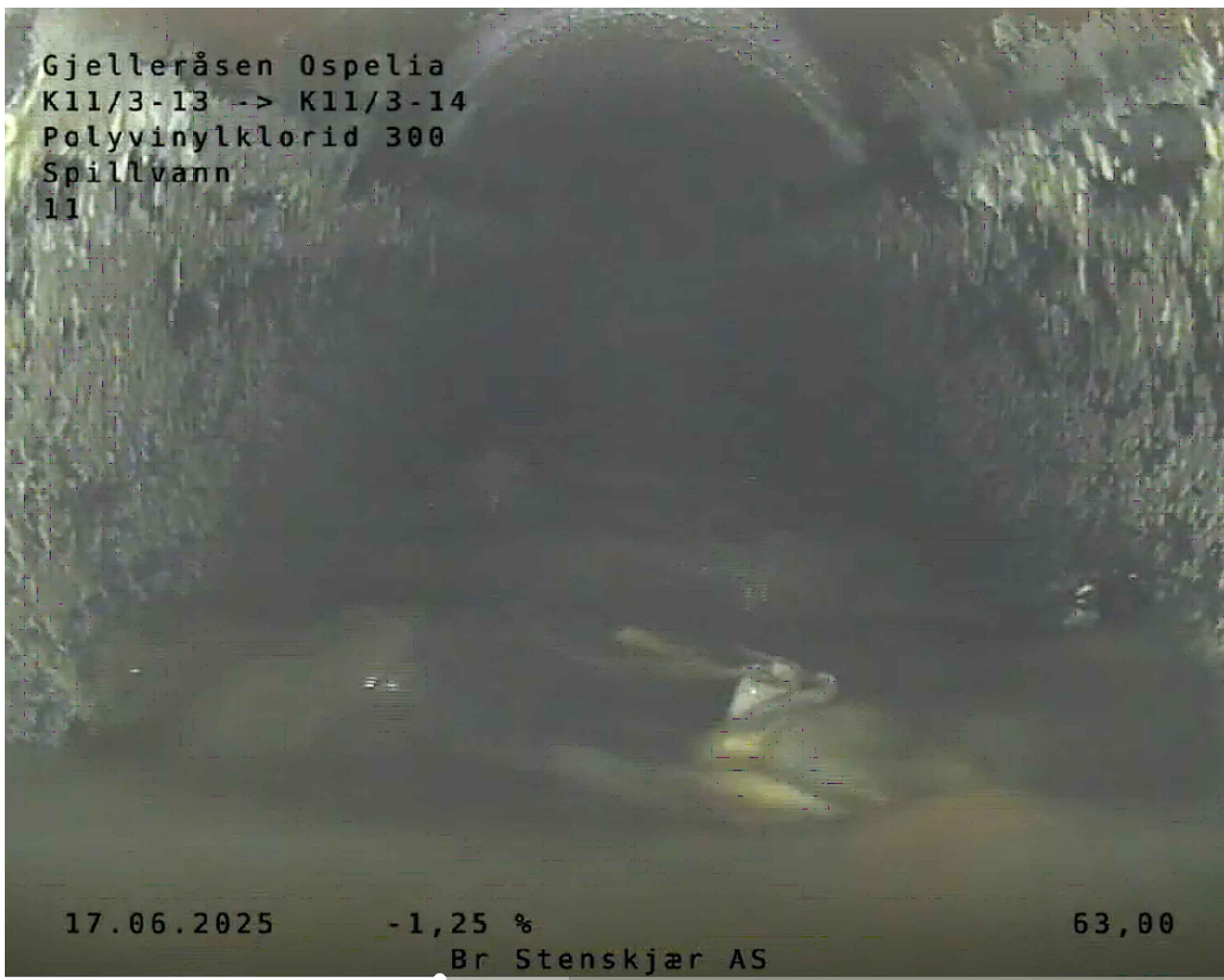
14.3 Deformasjon på røret, ca 1277m
